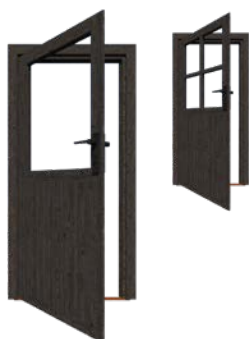
147002 Enkele deur glas, Vuren zwart linksdraaiend 78 x 193 cm* 147003 Enkele deur glas, Vuren zwart rechtsdraaiend 78 x 193 cm* Inbouwmaat: 86,5 x 199,5 cm Buitenwerkse maat kozijn: 91 x 201,8 cm
